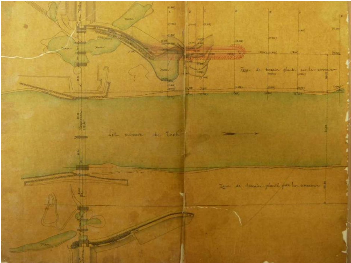
Fig. 7 - Plan du projet de prolongement de la digue du pont du chemin de fer sur le Tech, dressé par G. Sorel, ingénieur ordinaire, 16 février 1886. ADPO ADPO, 135W431. En rouge, le prolongement projeté.
